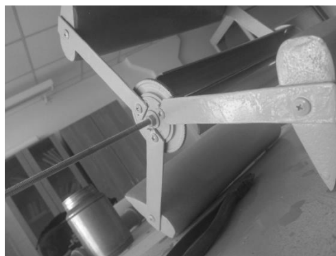
Рис. 1. Установка лопастей Савониуса в экспериментальную комбинированную ВО ВЭУ
