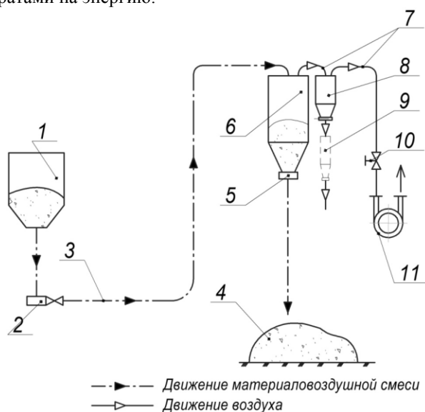
Рис. 1 Схема проектируемой вакуумной транспортной установки
