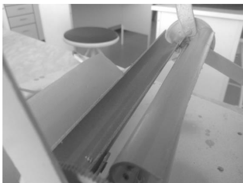
Рис. 1. Установка лопастей Савониуса в экспериментальную комбинированную ВО ВЭУ
